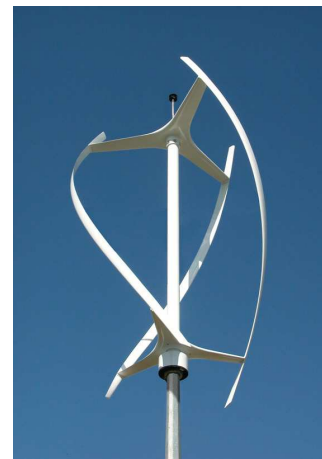
Kuva 6.5: Nostevoimaa hyödyntävä Giromill-roottori. [23]
