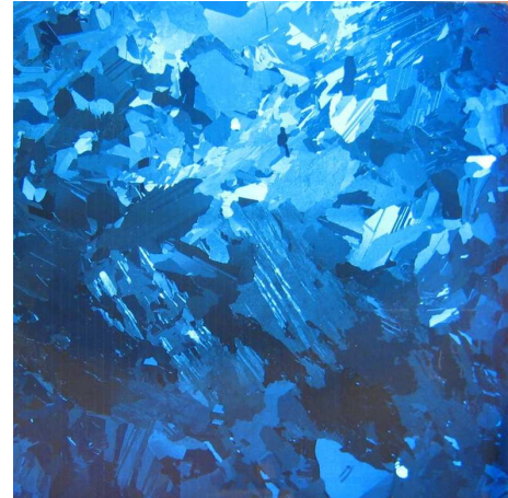
Kuva 4.15: Monikideaurinkokenno, jossa virtakontaktit ovat kennon takapinnalla.
