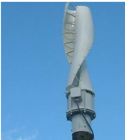
Kuva 6.4: Vastusvoimaa hyödyntävä Savonius-roottori. [81]
