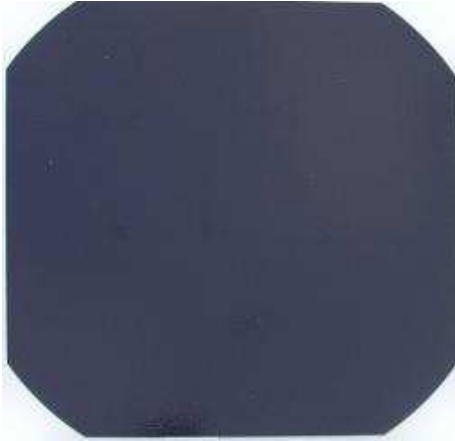
Kuva 4.14: Yksikideaurinkokenno, jossa virtakontaktit ovat kennon takapinnalla.
