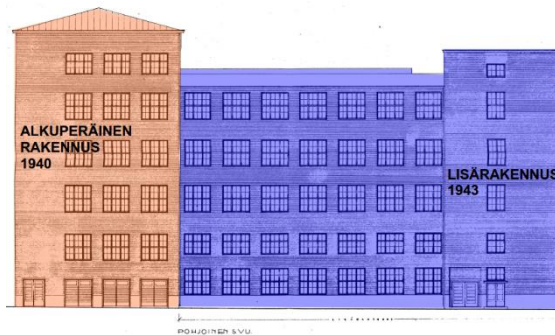
Rakennusvaiheet, Pohjoinen julkisivu
