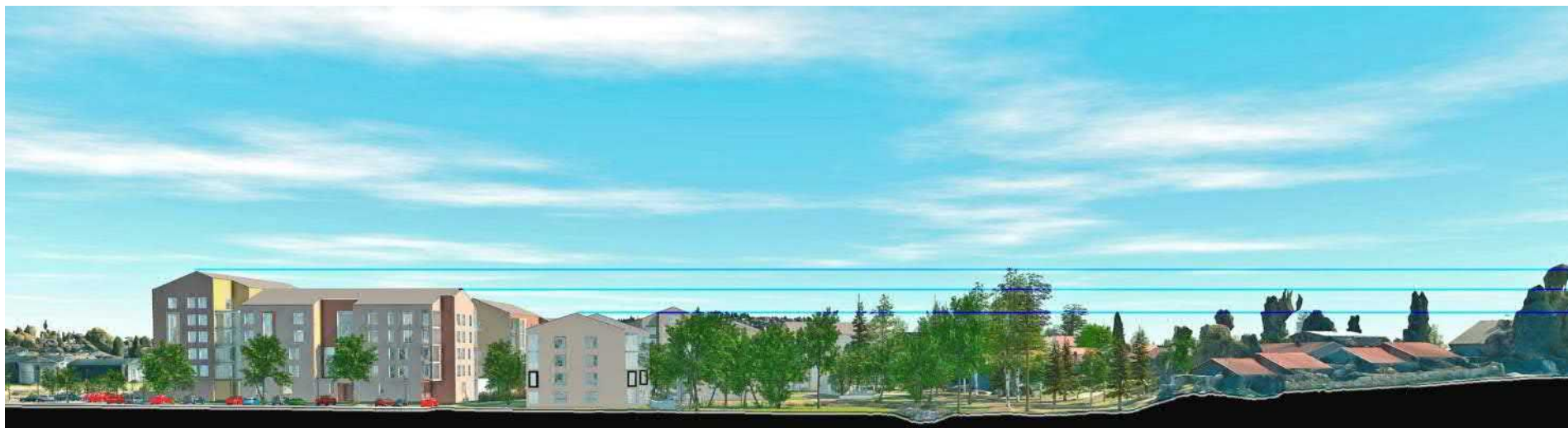
Pohjois-eteläsuuntainen leikkauskuvaa kaava-alueesta. Sinisillä viivoilla on verrattu uusien rakennusten harjakorkeuksia olemassa olevaan rakenteeseen.
