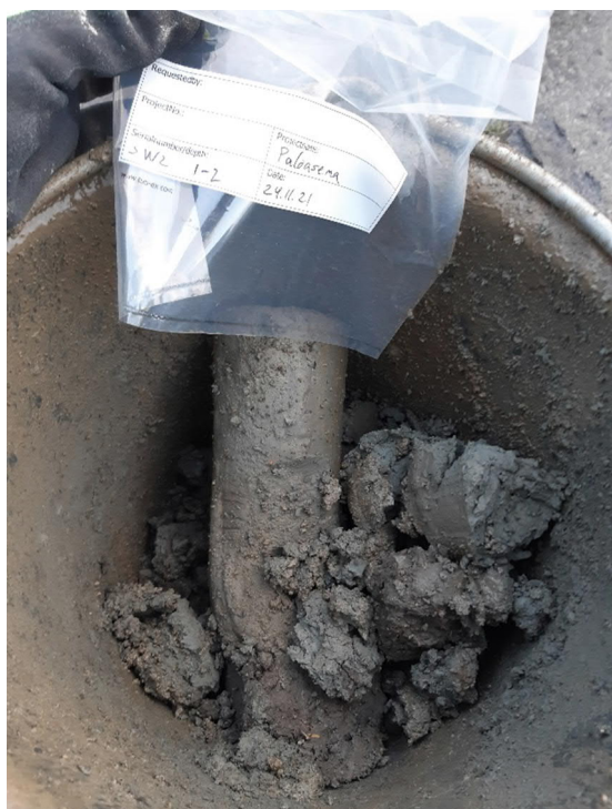
Kuva 3. Näyte syvyydellä 1–2 m näytepisteessä SW2. Maalaji savi.
