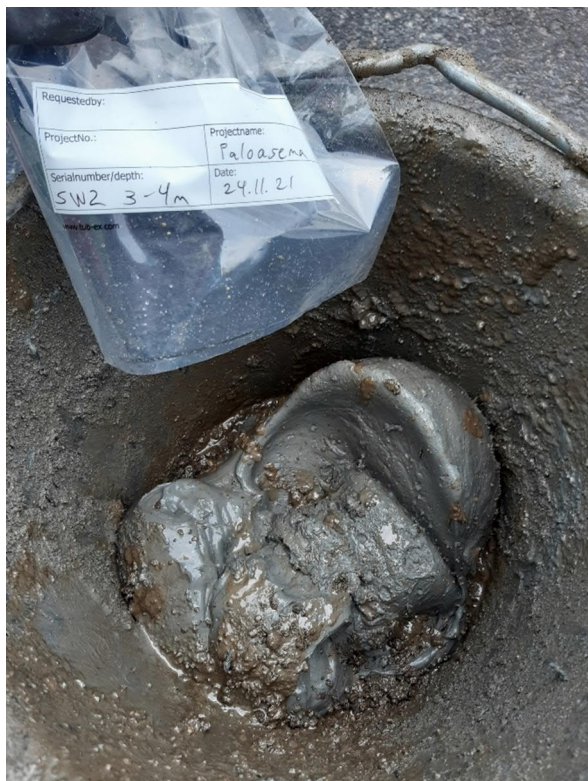
Kuva 4. Näyte syvyydeltä 3–4 m kairapisteessä SW2. Maalaji savi.
