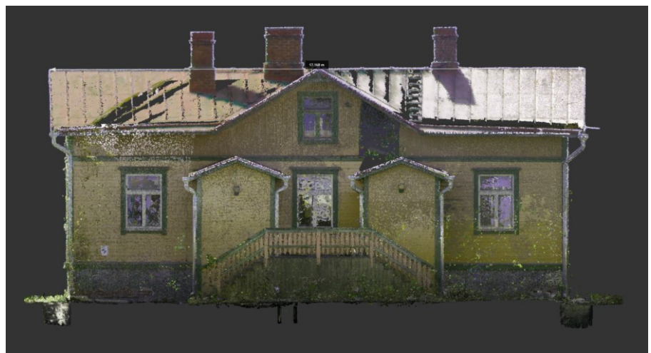
Kuvat 8 ja 9. Rakennus keilattu ja mallit näissä kuvissa. Kuvat: Tampereen kaupunki
