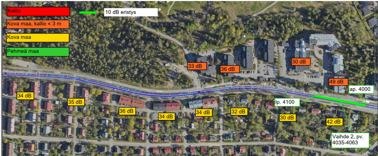
Kuva 14 Laskennalliset runkomelutasot ilman runkomelueristystä ja esitetty runkomeluvaimennus kiskonaluslevyjen lisäksi paaluvälillä 4000 – 4700. Tausta-aineistona Tampereen ilmakuva.
