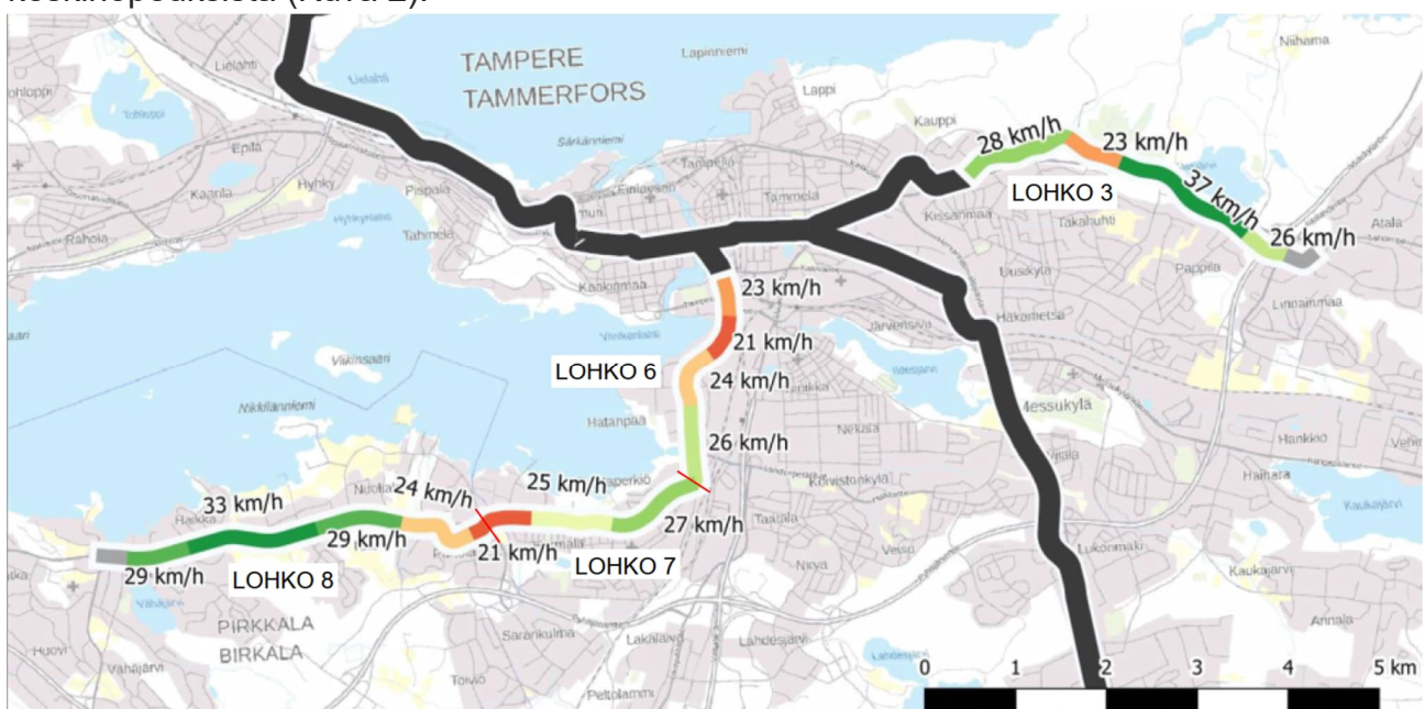
Kuva 2 Vaunujen keskinopeudet rataosuuksittain (Pirkkala-Linnainmaa raitiotien hankesuunnitelma).
