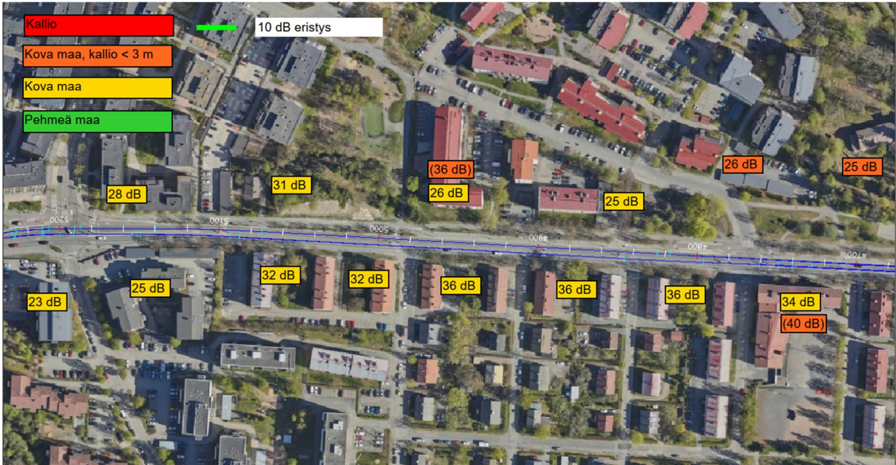
Kuva 15 Laskennalliset runkomelutasot ilman runkomelueristystä paaluvälillä 4700 – 5200. Sulkeissa olevat arvot mahdollisia, mikäli rakennus on kallionvarainen. Tausta-aineistona Tampereen ilmakuva.
