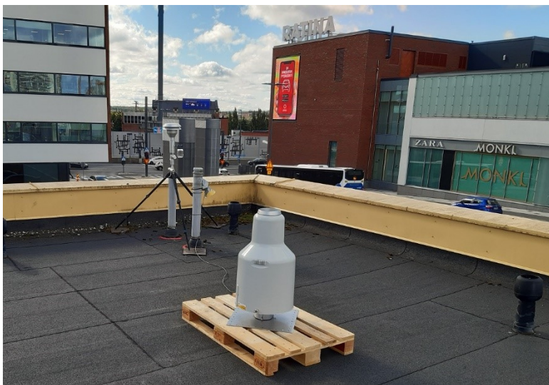
Kuva 1. Taka-alalla katon reunalla hiukkasanalysointin inlet ja NO x -analysointin sondi. Etualalla viheralueiden suunnitteluosaston hulevesikertymän seurannassa vuodesta 2022 alkaen hyödyntämä sademäärämittain.
