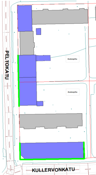
Kuva 4. Rakennusten vihreällä merkityille sivuille tulisi antaa kaavamääräys julkisivun 30 dB äänitasoerosta.
