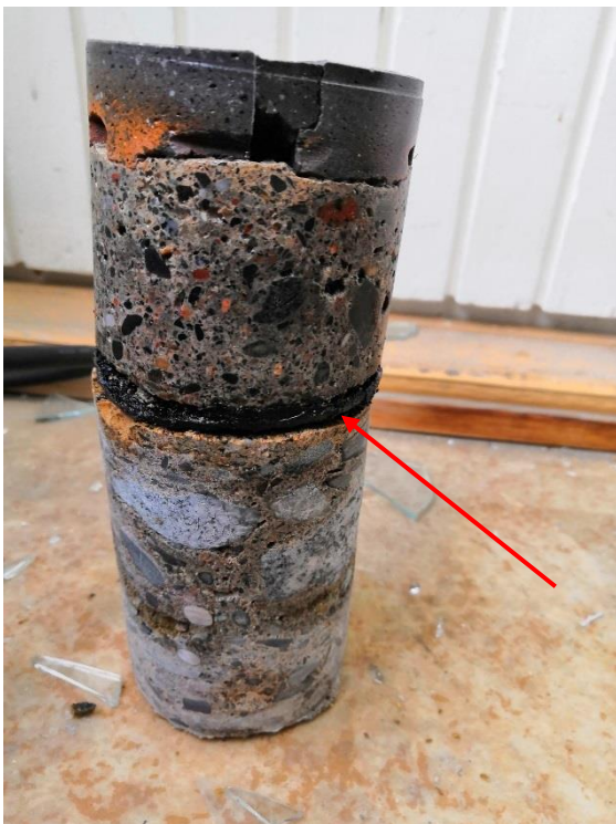
Näyte 2. vedeneristys sokkelista → ei sisällä asbestia ja PAH-yhdisteiden pitoisuus ei ylitä vaarallisen jätteen raja-arvoa.
