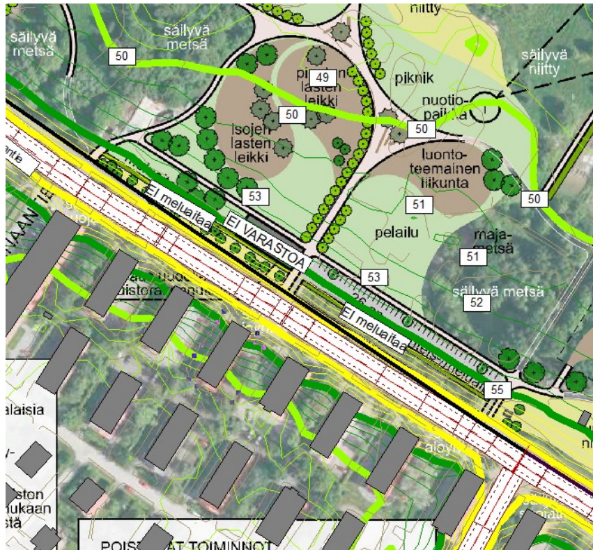
Kuva 1. Nekalantien varrella ei ole melulta suojaavia rakenteita, ei meluseinää, eikä varastorakennusta
