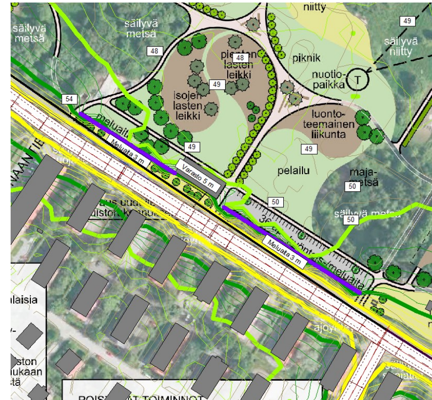
Kuva 2. Meluseinät (3 m) ja varastorakennus 5 m suojaavat Nekalantien autoliikenteen aiheuttamalta melulta
