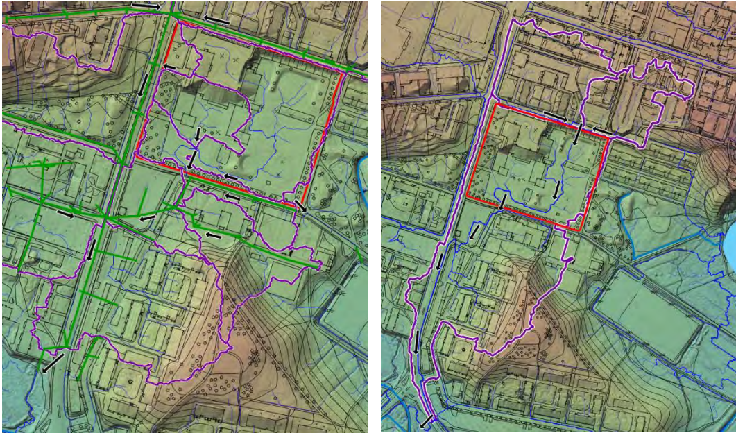
Kuva 2.2. Hulevesien virtausreitit ja valuma-alueet nykytilanteessa Tampereen korkeusmallin perusteella. Vasemmassa kuvassa hulevesiverkostot on kaiverrettu korkeusmalliin. Oikeassa kuvassa on esitetty tulvareitit korkeusmallin perusteella.
