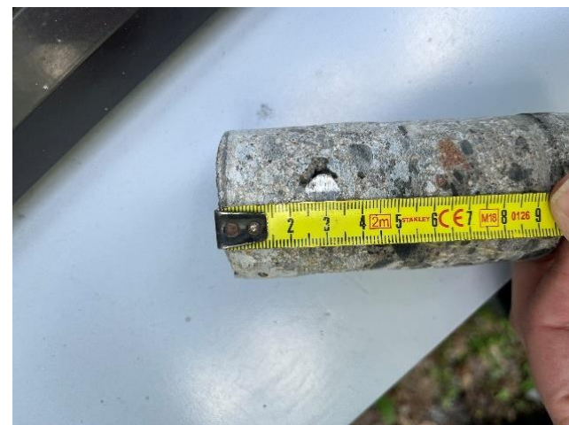
Kuvat 13 a ja b. Betonilieriöavaus BET15 alkuperäisosan tukimuriin. Porauksessa havaittiin suunnitelmien mukainen \varnothing 8 mm raudoitusteräs 25 mm syvyydellä ulkopinnasta.
