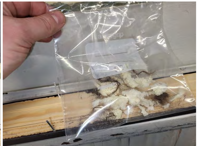
Kuvat 72 a-b. a) Tilan 294D ikkuna-seinäliittymä tiivistetty polyuretaanivaahdolla. b) Polyuretaanivaahdotuksen seassa on jäämiä vanhasta pellavariveestä. Pellavariveessä havaittiin aistinvaraisesti PAH-yhdisteisiin viittaava hajua.
