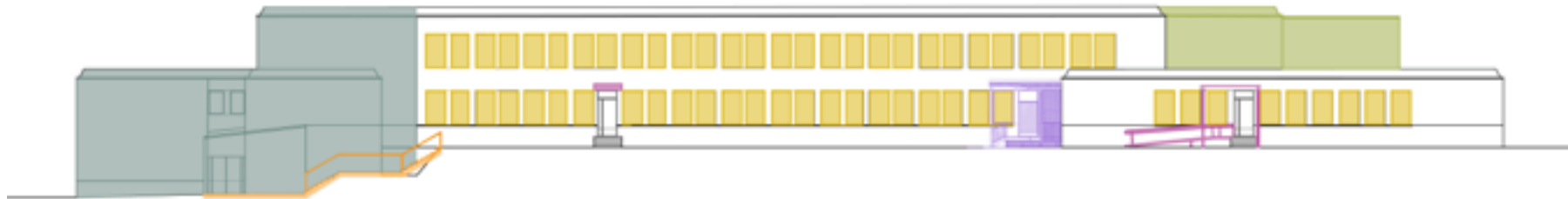
Julkisivukaavio pohjoiseen - Säilyneisyyskaavio rakenteista ja ikkunoista
