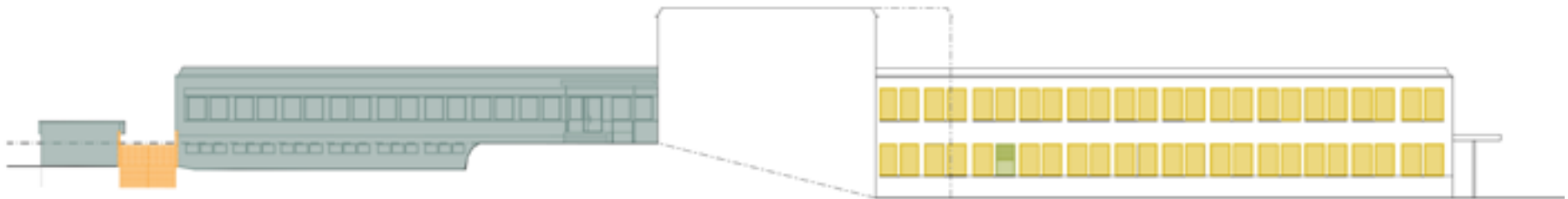
Julkisivukaavio länteen (sisäpiha) - Säilyneisyyskaavio rakenteista ja ikkunoista
