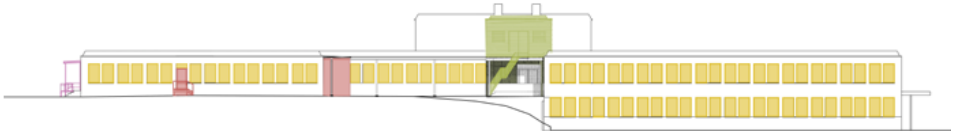
Julkisivukaavio länteen - Säilyneisyyskaavio rakenteista ja ikkunoista
