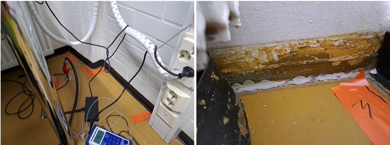
Kuvat 3 a-b. a) Merkkiainekokeissa merkittävää ilmavuotoa pilarin kohdalta ja sähkökourun kohdalta. b) Ulkoseinä-alapohjaliittymässä ei havaittu ilmavuotoa. Saumassa liimamassa/kitti.
