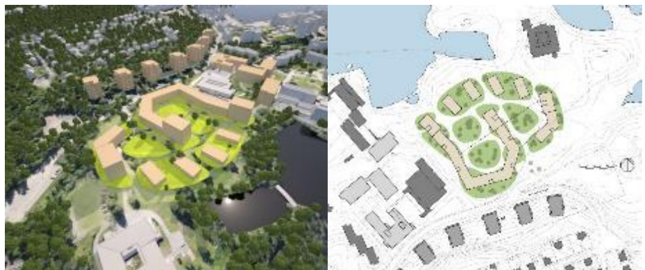
Vaihtoehto C, jossa lamellitalo rajaavat Rauhaniementien reunaa ja pienkerrostalot ova rannan puolella. Kerroskorkeus vaihtelee 2 - 8 kerroksen välillä ja kerrosalaa vaihtoehdossa on noin 27 000 k-m 2 , mikä tarkoittaa noin 540 asukasta.
