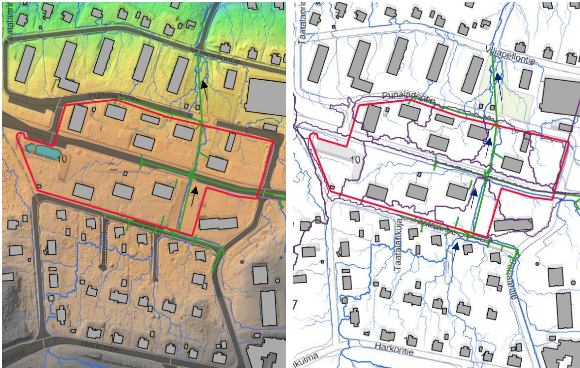
Kuva 2.3. Korkeustasot esitetty vasemmanpuoleisessa kuvassa. Punaisella aluerajaus ja vihreällä Tampereen Veden hulevesiviemäristö ja pintavaluntareitit (sinisellä) MML:n 2x2 pintamallin perusteella. Oikeanpuoleisessa kuvassa esitetty osavalmualueet (violetilla).
