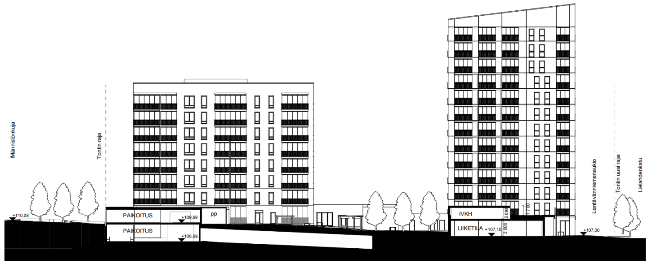
Kuva 9: Leikkaus pohjoisetelä-suunnassa. Kuva: Sweco Finland Oy.
