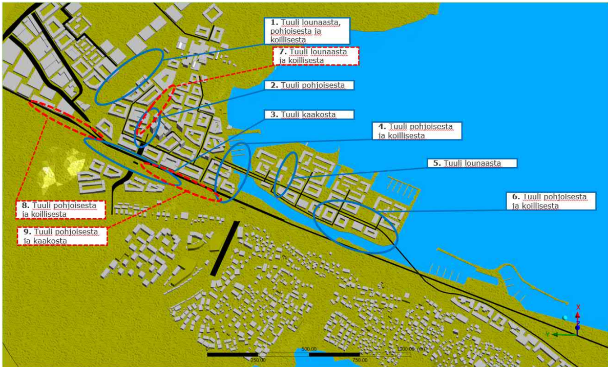
Kuva 36. Erityisen tuulelle alttiit kohdat Hiedanrannan alueen sisällä tarkasteltujen tuulitilanteiden pohjalta. Kuvassa ei ole erikseen korostettu alueen pohjoispuolista rantaviivaa, joka on kaikilla järven suunnalta puhaltavilla tuulilla hyvin tuulinen. Tuuliset alueet on ympyröity kuvaan sinisellä ja liikennepäästöjen kertymät punaisella värillä. Alueet on numeroitu 1 – 9 ja jokaisen alueen kohdalla havainto, esimerkiksi tuulisuus, voi toistua useammalla kuin yhdellä tarkastellulla tuulen suunnalla.
