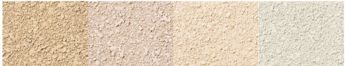
Pihajulkisivujen betoni- ja rappauspintojen ohjeellinen väriskaala
