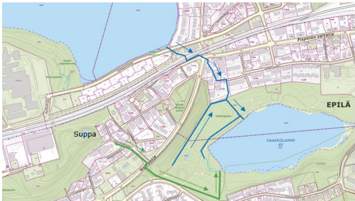
Kuva 3. Suunnittelualueen nykyinen hydrologia. Nykyiset hulevesiviemärit on kuvattu vihreällä ja nykyiset ojat sinisellä. (Lähde: kartat.tampere.fi/oskari )
